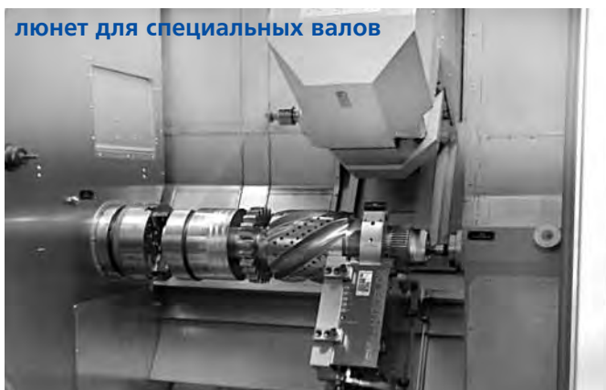
люнет с алмазными опорными сегментами для поддежки первичных валов при тяжелой проточке/шлифовке
