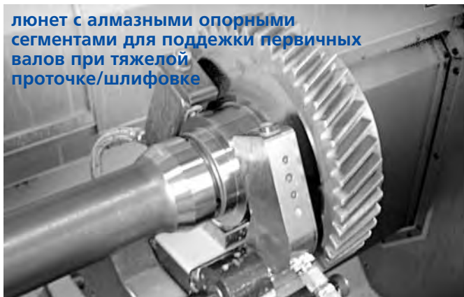
люнет для обработки валов в авиастроении
