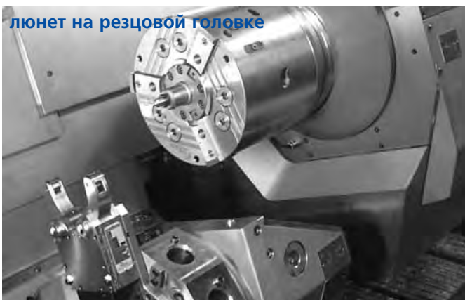
люнет для обработки валов в авиастроении
