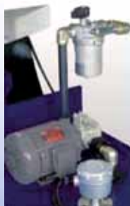
Подача СОЖ через шпиндель под высоким давлением 15/35 кг/см 2
