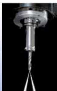
Подача СОЖ через шпиндель под высоким давлением 15/35 кг/см 2
