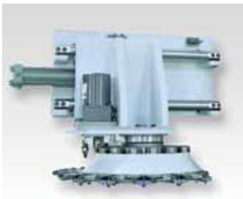
Устройство автоматической смены инструментов (Горизонтального типа)
