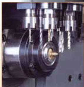
Шесть приводных инструмента: поперечное сверление/фрезерование/нарезание резьбы
