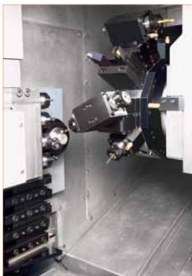
Главный шпиндель и противошпиндель со встроенными оптическими линейками MP и осью CS. Это позволяет достичь более высокой точности вращения шпинделя и лучшей обработки поверхности во время во время цикла обработки.
