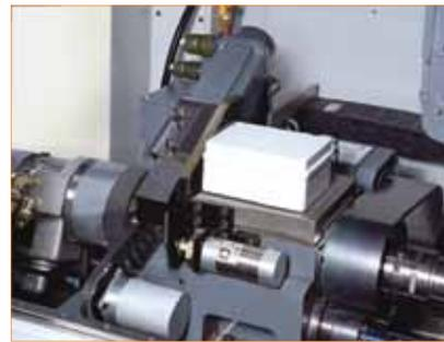
Поперечный приводной инструмент и угловая приводная головка помогут Вам проводить операции сверления, фрезерования и нарезания резьбы на наклонных и перпендикулярных поверхностях.
