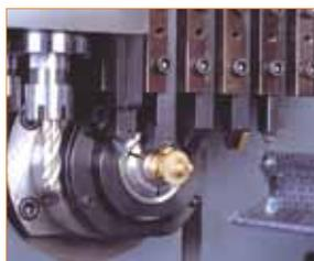
Шесть инструментов для внешней обработки
