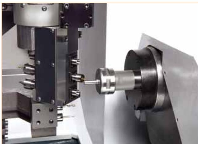
Компания Poly Gim представляет малогабаритный токарный станок швейцарского типа с ЧПУ: Diamond CSL 12-2Y, с наибольшим диаметром обрабатываемого прутка — 12 мм и возможностью работы до 10 осей.
