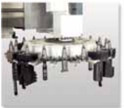
Автоматическая система смены инструмента типа М 16 позиций
