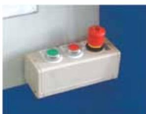
• Дополнительный блок вкл/выкл станка.
