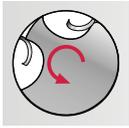
Метчики для нарезания резьбы в глухих отверстиях имеют меньший угол затылования режущего зуба, так как при реверсировании производится скалывание стружки около её основания.
