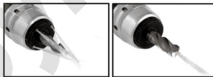
• СОЖ подается через 4 отверстия в зажимной гайке.
