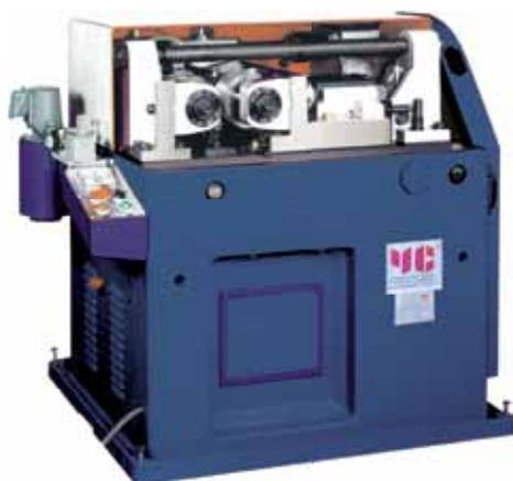
Модель YC-3Т оснащена функцией регулирования скорости вращения шестерни и регулировки скорости подачи, что обеспечивает качественное и прецизионное производство широкого ассортимента деталей с резьбой.
