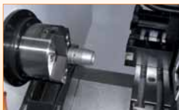
Действие 3: Патрон зажимает материал для обработки
