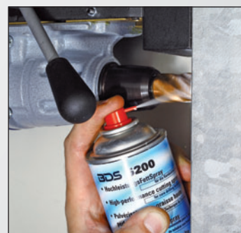
Этап 2: Во время сверления распыляйте высокопроизводительный смазочный спрей на конец сверла и внутрь отверстия.
