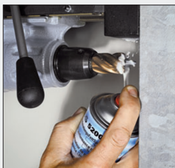
Этап 1: Перед сверлением распылите высокопроизводительный смазочный спрей прямо на сверло.
