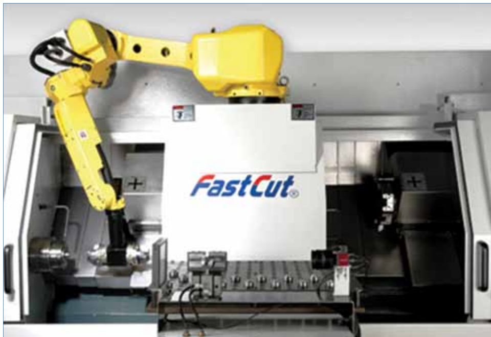
• Плечо робота для станка А.
