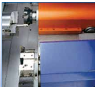
Полигональная обработка после точения
