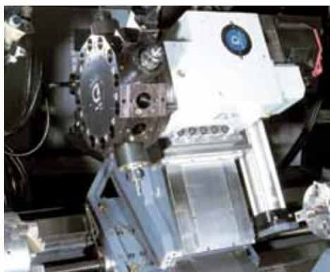
Y-направляющая под углом 30 градусов движется в двух направлениях по X-направляющей, которая также находится под углом 30 градусов, для того чтобы обеспечить комбинирование одно- или двухосного перемещения по X и Y. В частности добавлен балансировочный цилиндр, для обеспечения равных значений крутящих моментов в «+» и «-» направлениях движения.
