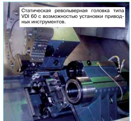
Статическая револьверная головка типа VDI 60 с возможностью установки приводных инструментов.
