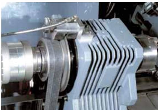
C-ось: существует 2 ступени уменьшения напряжения в зажатии C-оси для достижения высокой точности и стабильность во время операций точения и фрезерования.
