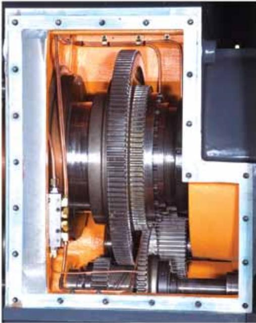
Шпиндельная бабка VT-40 имеет систему смазки с системой контроля температуры.
