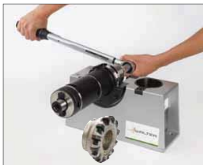
10. Затянуть динамометрическим ключом.
