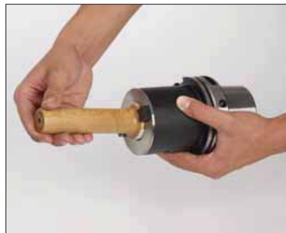
3. Очистить внутреннюю поверхность конуса и опорную поверхность.
