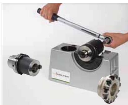
7. Затянуть динамометрическим ключом.
