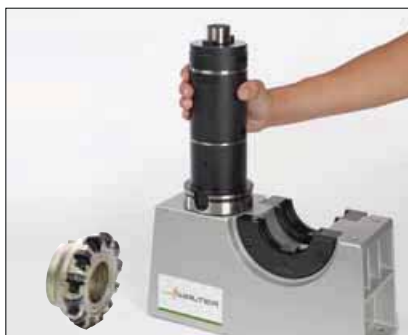
11. Установить собранный базовый держатель в коническую втулку.
