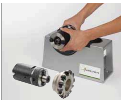
8. Вставить базовый держатель в соответствующий фланец.
